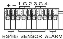
**Entrada de Alarme:** conecte a porta [-] de seu sensor ao pin G (GND), e a porta [+] à entrada do canal de acordo com o dispositivo de alarme adquirido. / **Saída de Alarme:** indicam as duas portas marcada como “OUT”.
